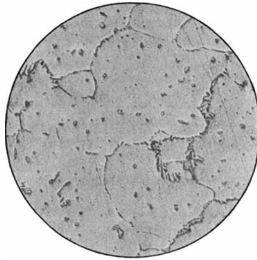
Fig. 4. — Lin. Vergr. 210. FeAl 3 -Kristalle als natürliche Verunreinigung in uneingeformtem Gußaluminium mit 0,5 v. H. Eisen. Ungeätzt.
